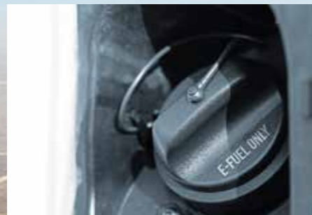
E-FUELS ONLY Über einen speziellen Tankstutzen sollen e-Fuel-Verbrenner nach 2035 nicht konventionell befüllt werden können
